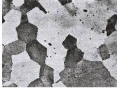
Rys. 9. Stal Hadfielda - 1,2 % C, 12 % Mn (pow. x 50). Austenit [ www.sciaga.pl ]
