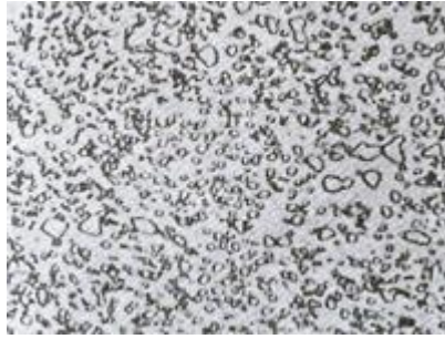
Rys. 7. Stal o zawartości ok. 1,2 % C (pow. x 1500). Cementyt kulkowy; cementyt (kulki) i ferryt (jasne tło) [ www.sciaga.pl ]
