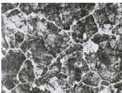
Rys. 6. Stal o zawartości ok. 1,3 % C (pow. x 100). Cementyt (jasna siatka) i perlit (ciemne tło) [ www.sciaga.pl ]
