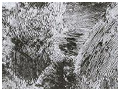
Rys. 3. Stal o zawartości ok. 0,8 % C (pow. x 500). Perlit [ www.sciaga.pl ]
