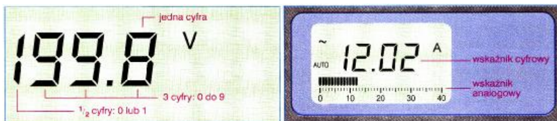
Rys. 30. Wyświetlacz siedmiosegmentowy 3 1/2 cyfry (po lewo) i cyfrowy wyświetlacz przyrządu wielozakresowego (po prawo) [1, s. 160]
