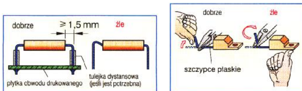
Rys. 12. Zaginanie wyprowadzeń elementów [1, s. 199]
