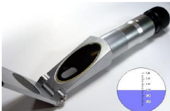
Rys. 7. Refraktometr - odczyt gęstości w okularze [13 b]
