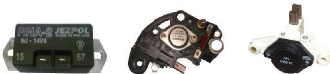
Rys. 23. Przykładowe regulatory elektroniczne alternatorów [13b]
