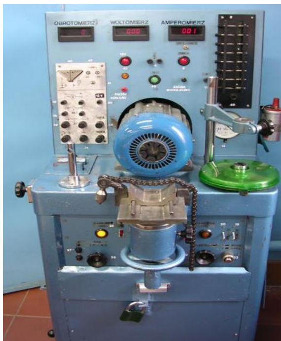
Rys. 18. Stół probierczy do badań osprzętu elektrycznego pojazdów samochodowych
