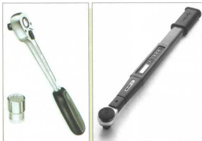
Rys. 6. Pokręta specjalne do nasadek kluczowych: zapadkowe (z lewej), dynamometryczne uniwersalne z prawej [10, s.26]
