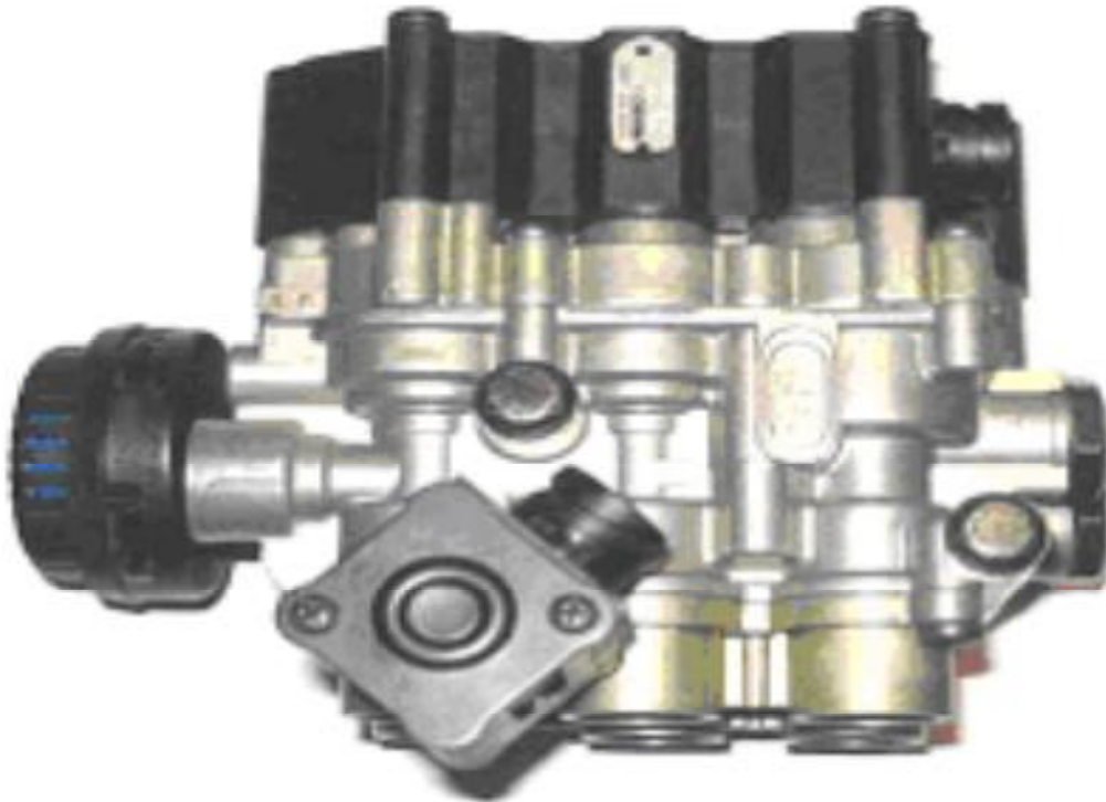
Rys. 3. Zawór elektromagnetyczny z czujnikami przemieszczenia umożliwiającymi obniżanie autobusu w celu umożliwiania pasażerom wsiadanie i wysiadanie [1, s. 7]
