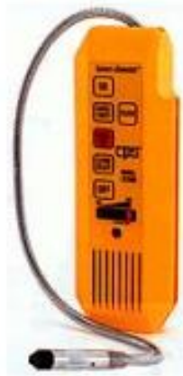
Rys. 6. Typowy elektroniczny wykrywacz nieszczelności [8]
